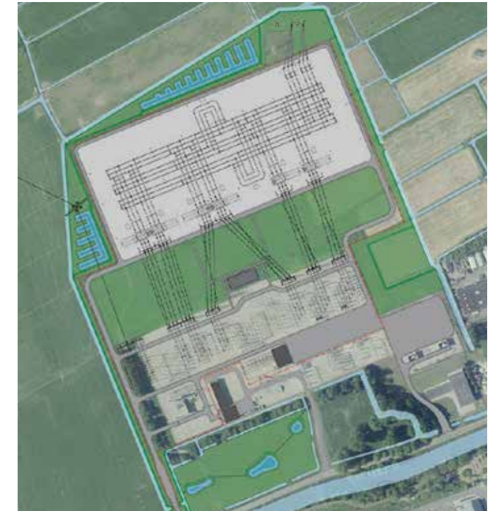
3.6 Uitbreiding station Vierverlaten t.b.v. netverzwaring. In de toekomst zullen meer grote verzwaringen en uitbreidingen nodig zijn voor voldoende transportcapaciteit
