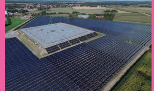
2.43 Voorbeeld van seizoensopslag voor warmte; een groot heet watervat (seasonal heat pit storage) in Gram, Denemarken
