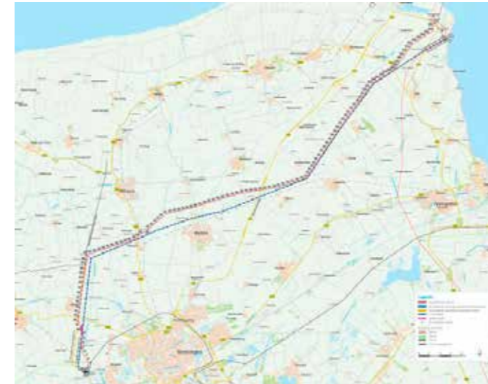
3.5 Een nieuwe 380kV verbinding tussen Eemshaven en Vierverlaten vervangt de 220kV verbinding en vergroot de afvoercapaciteit vanuit Eemshaven
